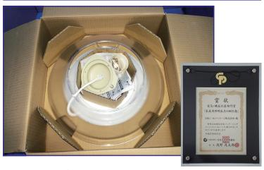
家庭用吊り下げタイプ照明器具の梱包において、包装の役割と機能を損ねることなく、梱包作業者視点に立った包装仕様を開発し、従来仕様から梱包作業性の向上と梱包材料の削減、低コスト化を実現しています。
