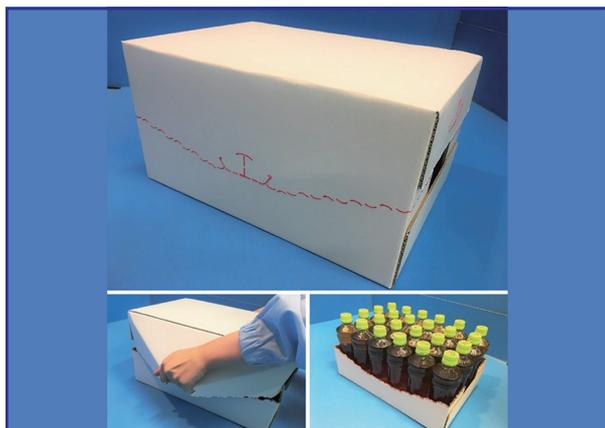
シェルフレディパッケージングにおいて、開封性と耐圧強度の向上を図っています。波型形状の切刃を入れることにより簡単できれいに開封できます。また、波型形状に工夫をし、段積みした際、上からの圧力が逃げるようにしています。さらに、波型形状の切れ刃を反転させ、端を若干ずらすことにより、横からの衝撃で外装箱が開かないようしています。
